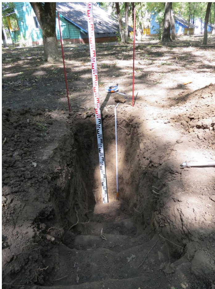
Рис. 6. Чернозём южный на лессовидных суглинках (пробная площадка № 1). Ставропольский край, с. Лесная Дача, Леснодаченский лесной массив, МАУДО «ДООЦ «Лесная сказка» август 2023 г.
